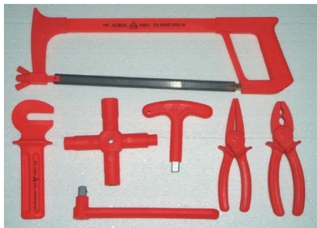
Рис. 3. Пример изоляционных инструментов (изолированные части – сигнального ярко-красного цвета)
